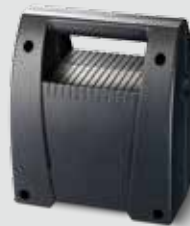
Accu-pack Nominale spanning 12 V DC, Nominale capaciteit 15 Ah, Economische levensduur van 40 dagen bij maximaal 4 openingen per dag bij een temperatuur van 20 °C, Temperatuurbereik - 15 ° bis + 45 °C, geïntegreerde laadregelaar voor voeding. • Alleen toepasbaar op: Novomatic 423 Accu
