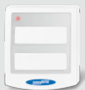
Draadloze binnendruknop Signal 111 Tweekanaals, 433 MHz, KeeLoq- Wisselcode ten behoeve van 2 aandrijvingen of 1 aandrijving en 1 buitenverlichting
