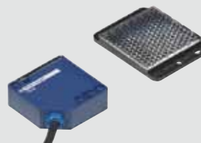
Veiligheidssensor met reflector Extra 628 • geschikt voor 24-240 V AC, 12-240 V DC, IP 54 • reikwijdte 5 m
