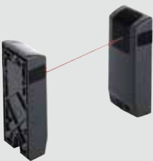
Fotocel met afzonderlijke zender en ontvanger Extra 625 • geschikt voor 24 V DC, IP54 • reikwijdte 8 m
